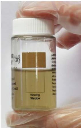
3. Mire a través de la ventana de visualización de la botella. Compare el color de la Solución de prueba con el patrón de prueba impreso sobre la ventana de visualización.
